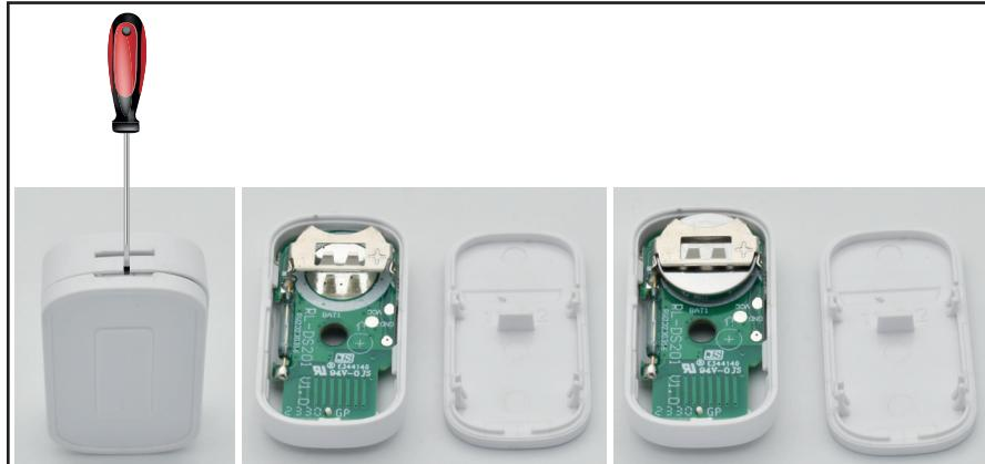
Se allontanando il magnete il LED non si accende, sostituire la pila a bottone 1632.
