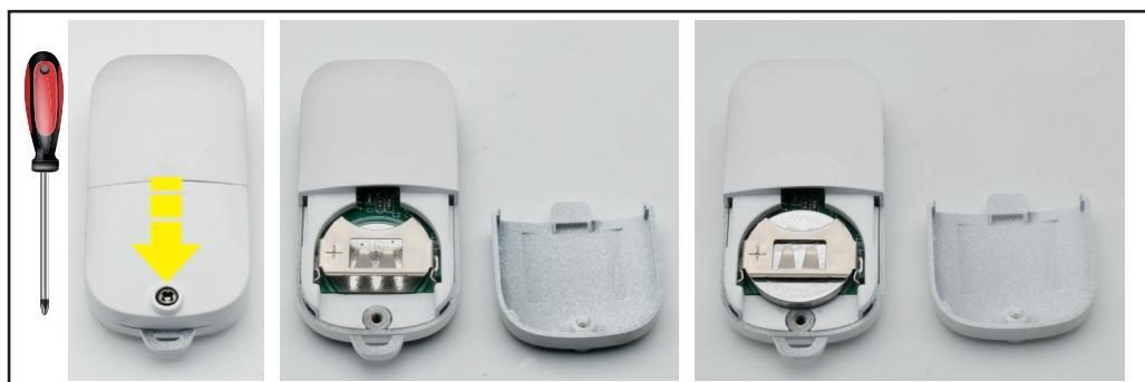
Als de LED niet gaat branden wanneer er op een knop wordt gedrukt en/of als de radiobesturing niet werkt, vervang dan de CR2032 knopcel.
