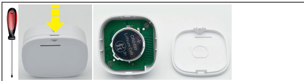
Se passando davanti al sensore, il LED non si accende, sostituire la pila a bottone 2450.
