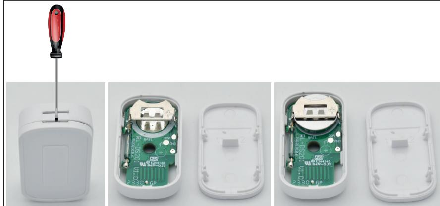
Si la LED ne s'allume pas lorsque le magnét est retiré, remplacez la batterie bouton 1632.
