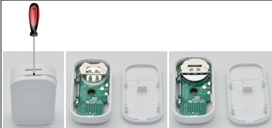
Als de LED niet gaat branden wanneer de magneet wordt verwijderd, vervang dan de knoopcel 1632.
